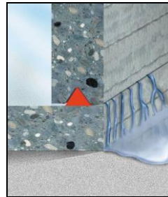
Con SikaSwell® S-2, el agua pasa, al comienzo, en una cantidad cada vez más limitada.
