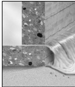
Sin el sello, el agua fluye a través de la junta de hormigonado.
